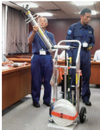
初期消火用スタンドパイプ
